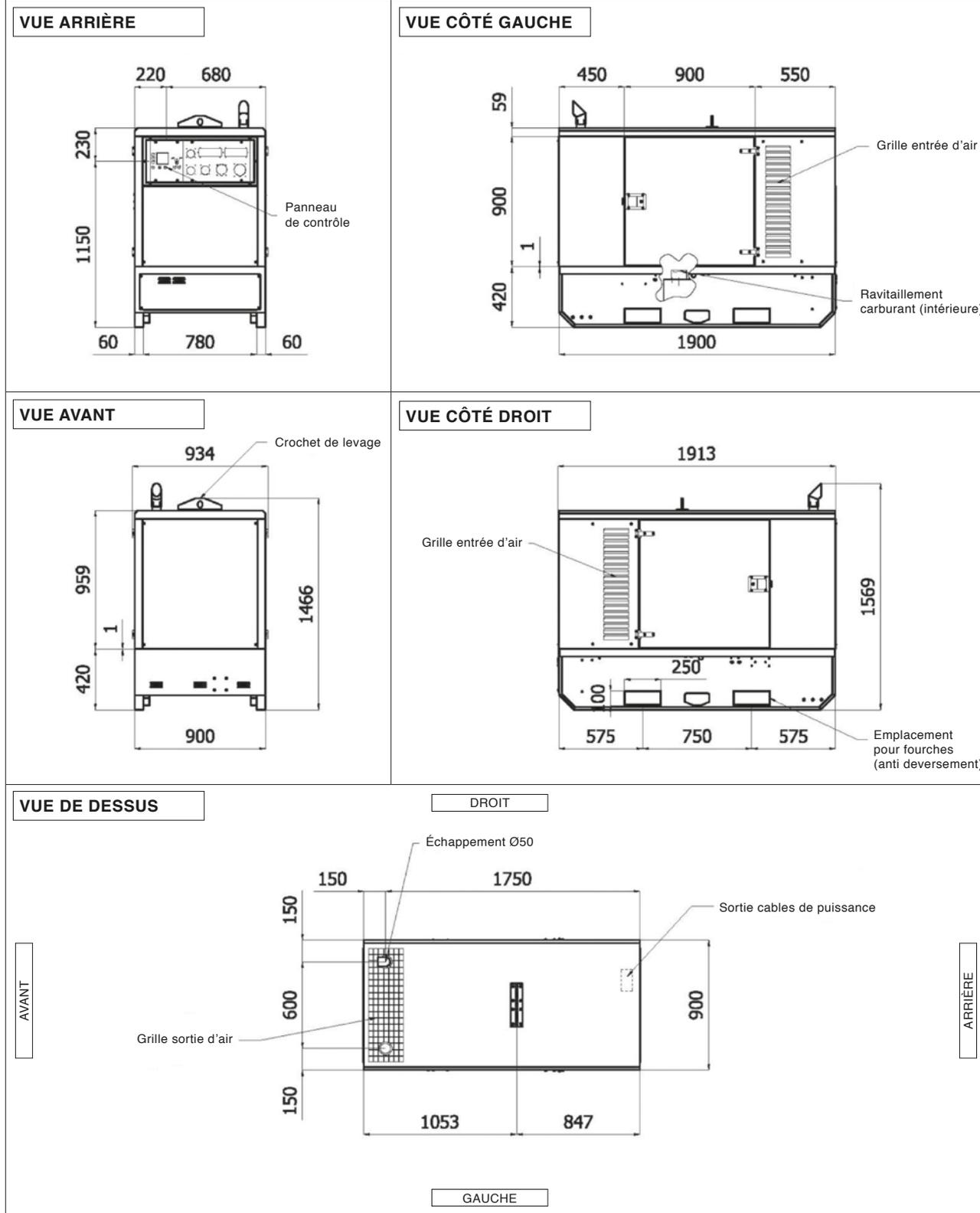
1) Les formes et dimensions sont pour un groupe électrogène standard du catalogue.
