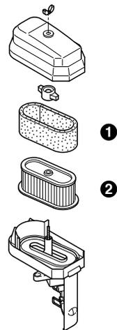
Nettoyer et changer plus souvent les éléments du filtre à air si le moteur est utilisé en environnement poussiéreux.
