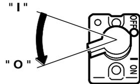
4. Pour les modèles à démarrage électrique, tourner la clé du contacteur sur la position «O» (ARRÊT)
