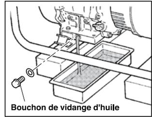
Utiliser de l'huile neuve de haute qualité jusqu'au niveau spécifié. Si de l'huile sale ou de qualité inférieure est utilisée ou si la quantité d'huile pour moteur n'est pas suffisante, le moteur sera endommagé et sa durée de vie considérablement réduite.
