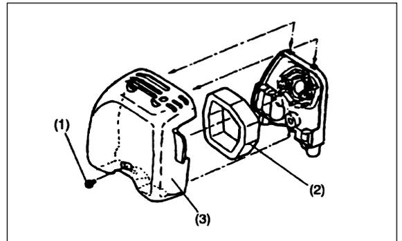
**REMARQUE:** Si la poussière et la saleté adhérant au filtre à air sont excessives, le nettoyer tous les jours. Un filtre à air bouché peut rendre le démarrage du moteur ou l'augmentation de la vitesse de rotation du moteur difficile ou impossible.
