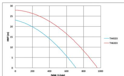
Les modèles TH offrent des solutions de pompage performantes, elles sont conçues pour les eaux chargées (granulométrie jusqu'à 20 mm). Des matériaux de hautes performances tels que la garniture mécanique en carbure de silicium et le corps de pompe en fonte d'aluminium moulé injectée sous pression offrent une excellente fiabilité et longévité.
