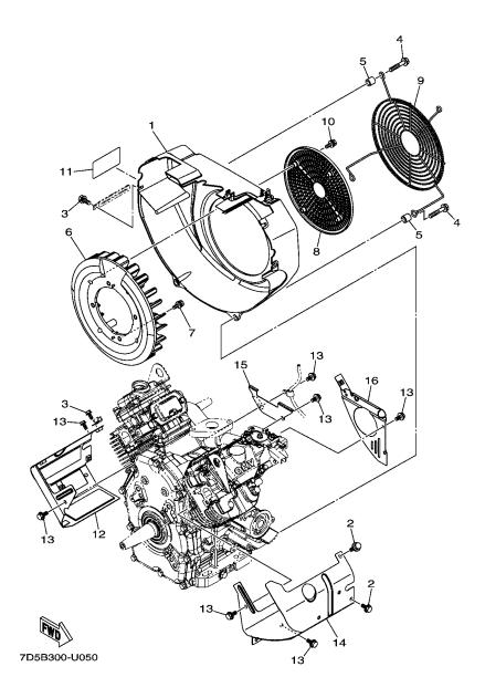
FIG. 5 AIR SHROUD & STARTER
